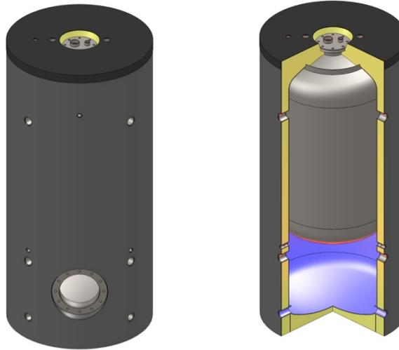
Gli accumulatori tampone con accumulatore d'acqua potabile integrato possono essere utilizzati con fonti d'energia convenzionali e alternative come accumulatori ausiliari. Integrati da un riscaldatore elettrico (accessorio), gli accumulatori possono essere utilizzati anche come accumulatori elettrici o accumulatori combinati.
